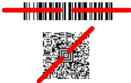
Halten Sie den Scanner über den Barcode, drücken Sie den Trigger und richten Sie den Zielstrahl mittig über den Barcode.
